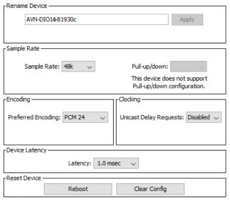
Fig 12: Device Config tab
