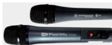
Das Flashmic trägt die Handschrift des Mitentwicklers Sennheiser. Mit 420 Gramm ist es kaum schwerer als der kleine Bruder aus der Evolution Serie mit 344 Gramm.
