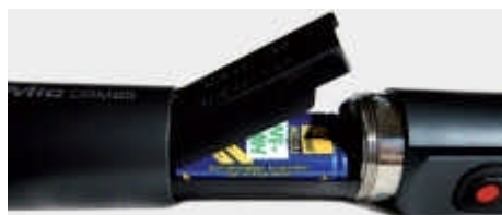
Zwei AA-Akkus mit 1600 mA sorgen für rund acht Stunden Betrieb. Das Batteriefach ist leicht zugänglich und über einen Schraubverschluss gesichert. Da klappert und wackelt nichts.
